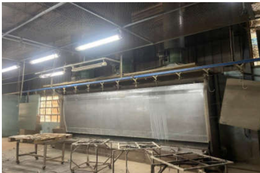
Hình 4.11. Hệ thống xử lý bụi, hơi dung môi từ công đoạn sơn màng nước
